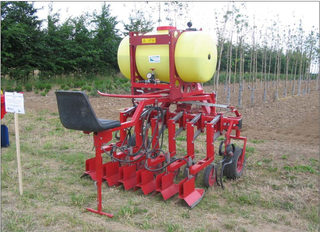
Obr. 16: Celozáhonový meziřádkový postřikovač. Foto: Kovář.
