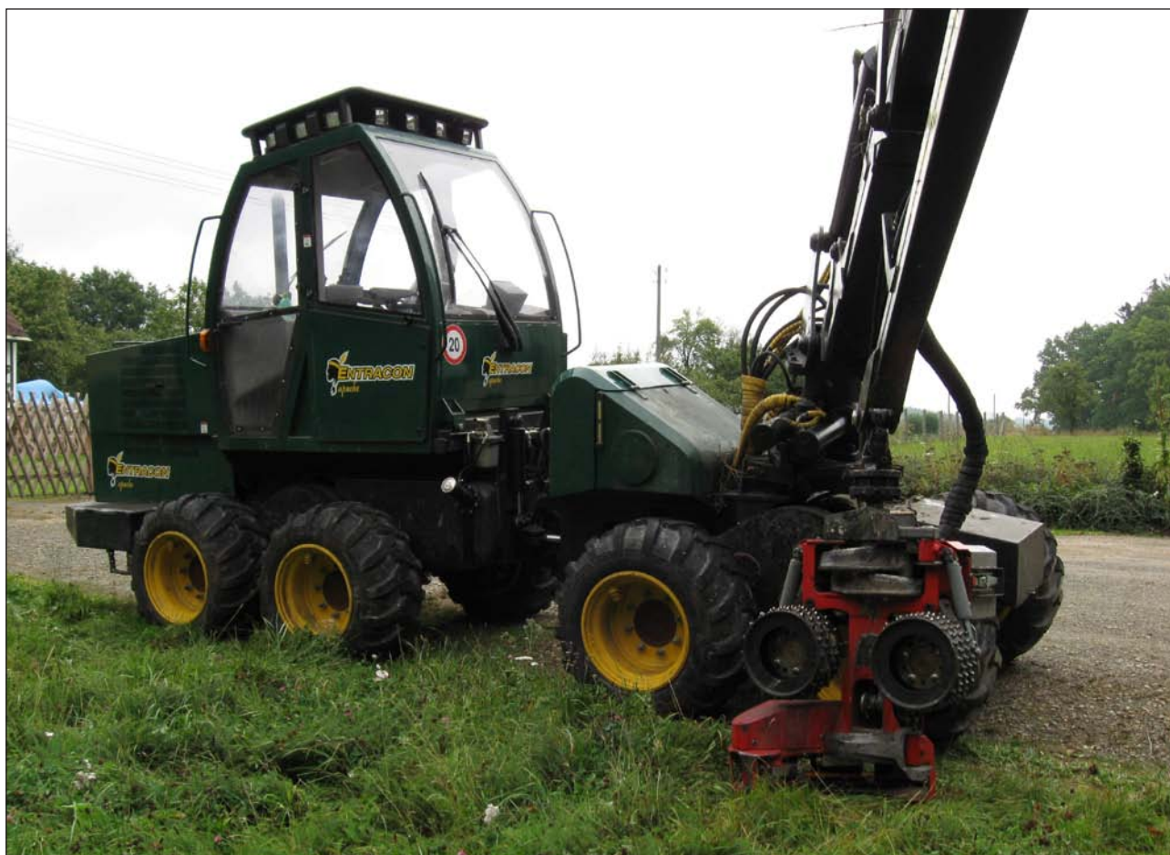
Obr. 23: Malý harvester pro první probírky. Foto: Kovář.
