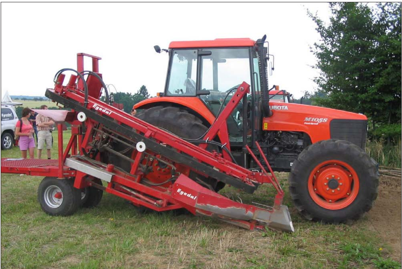
Obr. 18: Jednořádkový vyoravač sazenic. Foto: Kovář.
