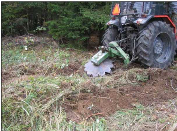
Obr. 39: Jednokotoučová fréza pro pruhovou přípravu půdy. Foto: Kovář.
