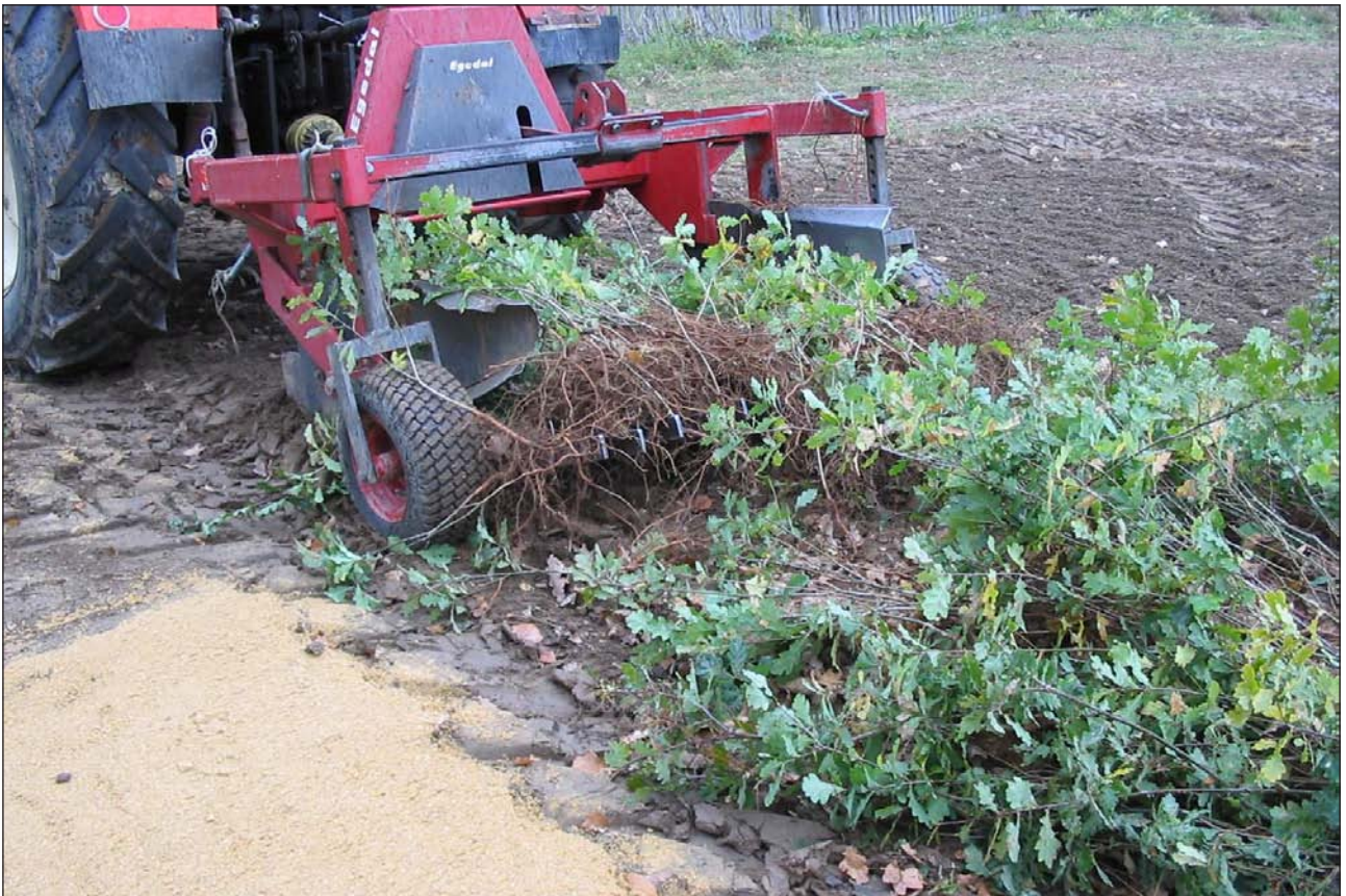
Obr. 20: Celozáhonový vyzvedavač sazenic s vytřásacím zařízením. Foto: Kovář.
