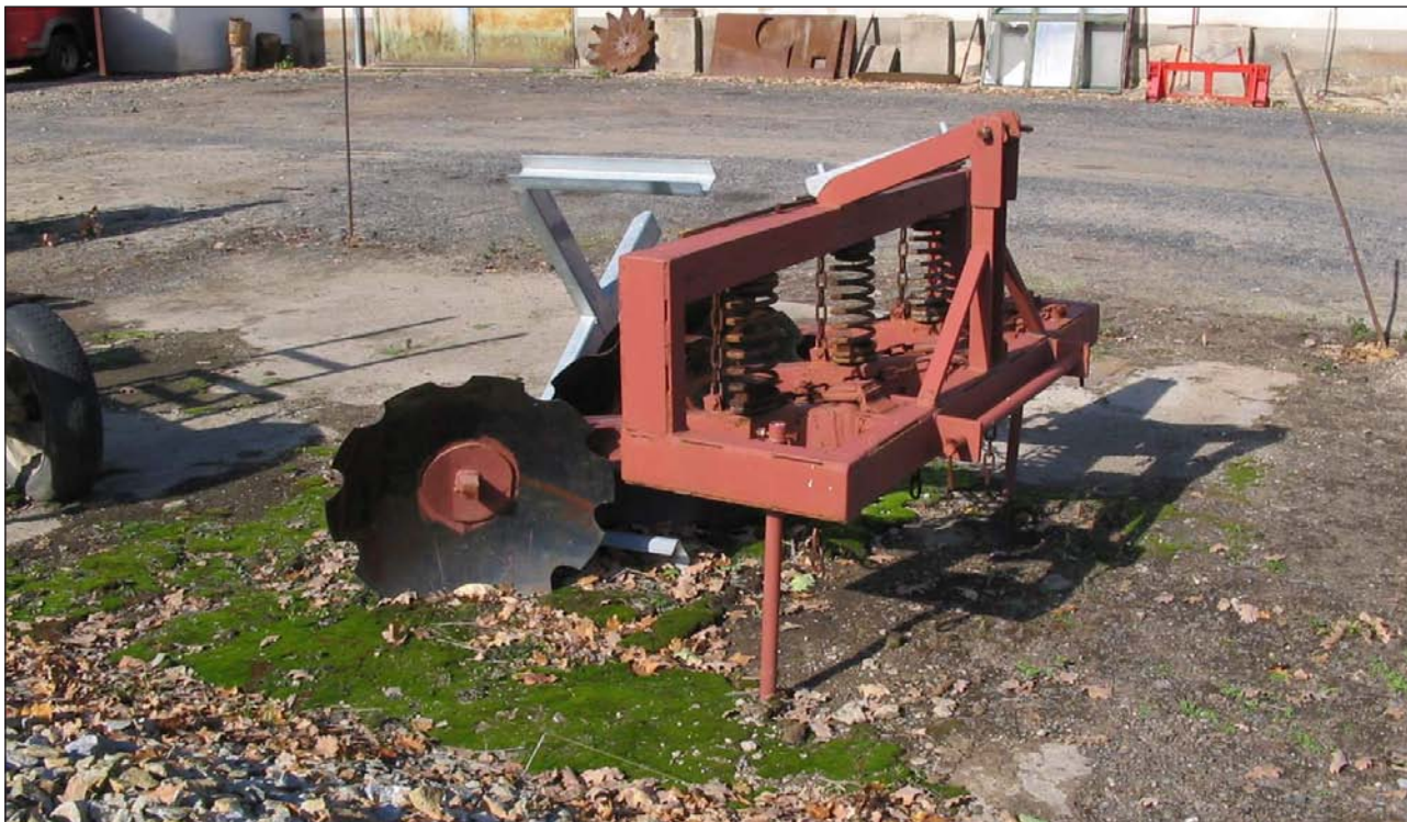
Obr. 43: Diskový zraňovač půdy pro podporu přirozené obnovy. Foto: Kovář.
