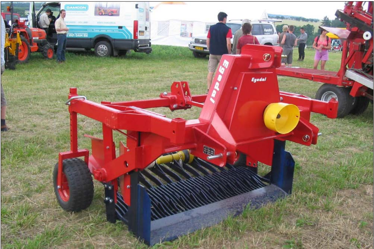
Obr. 17: Celozáhonový vyzvedavač sazenic s vytrásacím zařízením. Foto: Kovář.
