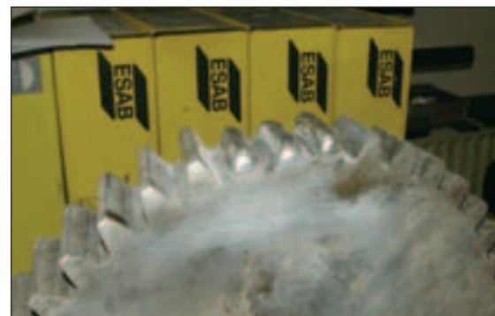
Obr. 3 Částečně opravené ozubení
