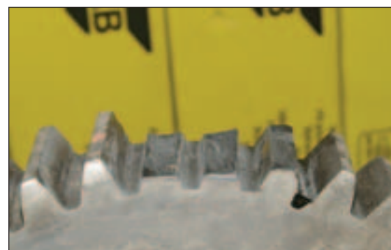
Obr. 2 Vybrúsené poškodené zuby pripravené k opravě
