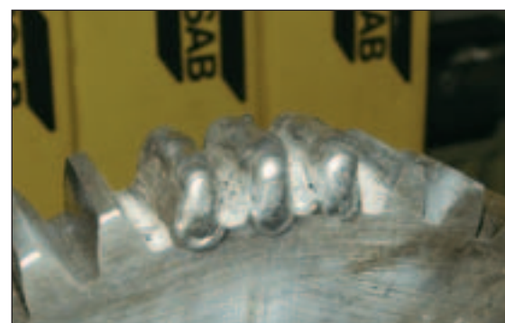
Obr. 4 Kompletně opravené ozubení připravené k finálnímu opracování na konečný tvar
