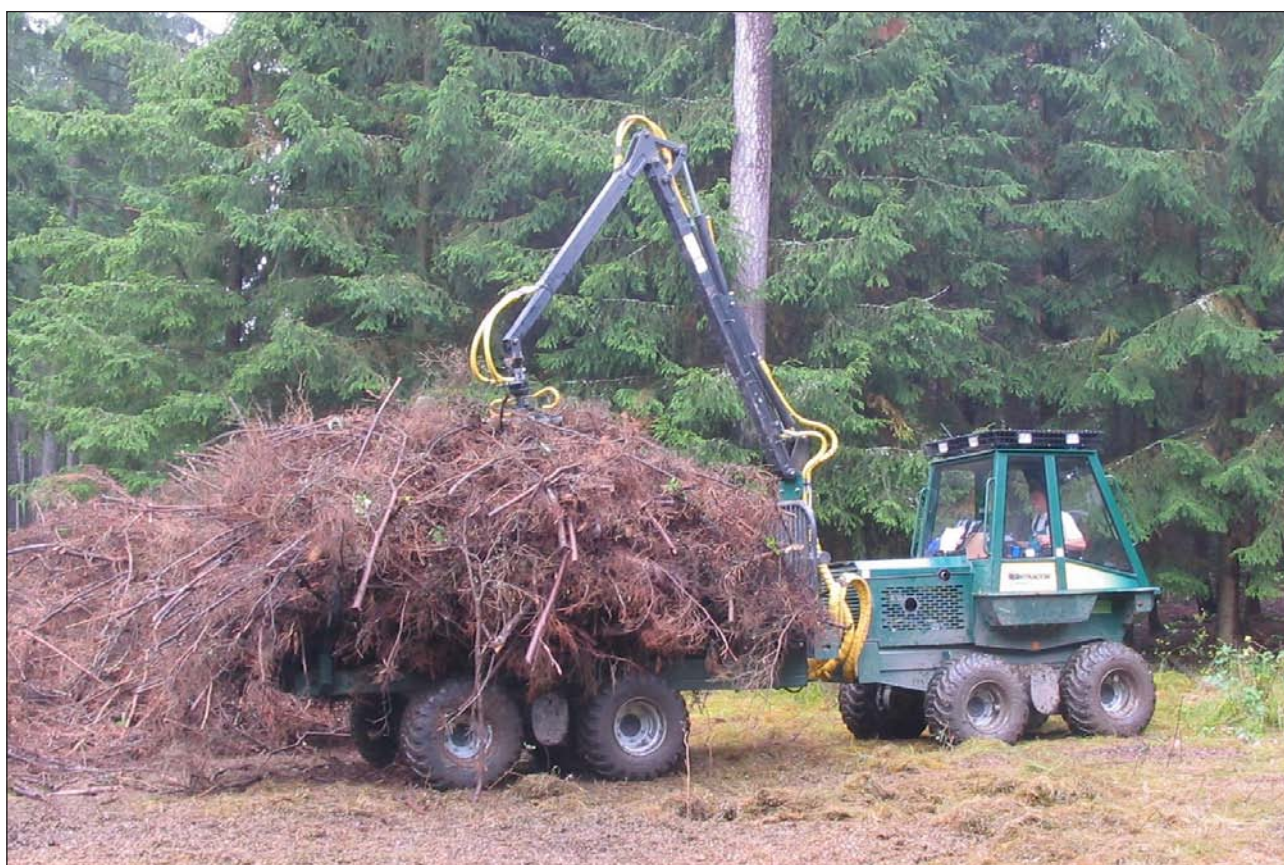
Obr. 38: Vyvážení klestu malou vyvážecí soupravou. Foto: Kovář.
