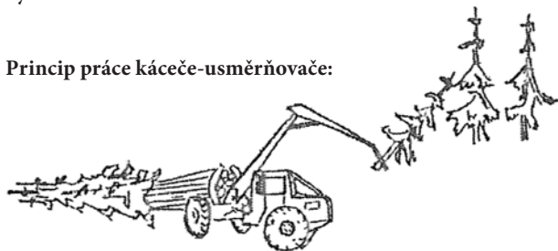
Káčeč-uměrnovač má vždy káček zařízení na robustním výložníku.
