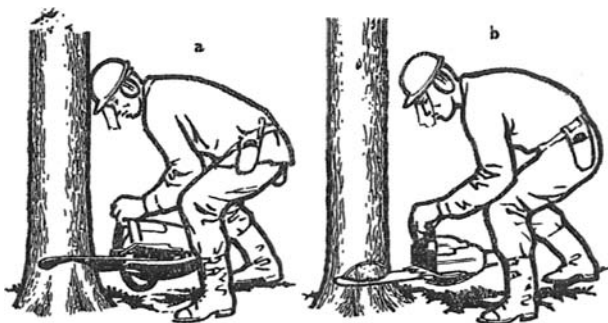
Zásek u slabších kmenů, kdy užitečná délka vodící lišty je větší než průměr káceného stromu (běžně asi 20 – 25 cm): a – šikmý řez se provádí odbíhajícím řetězem; b – vodorovný řez se provádí odbíhajícím řetězem.
